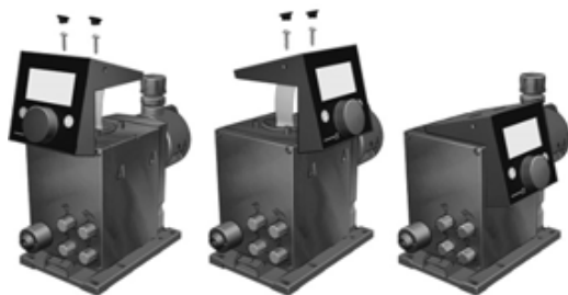
Fig. 3 Modularidad de la caja de control
