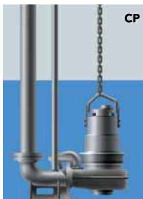
Para instalaciones semipermanentes en pozo húmedo. La bomba se monta en dos barras-guía, acoplada a una conexión de descarga.
