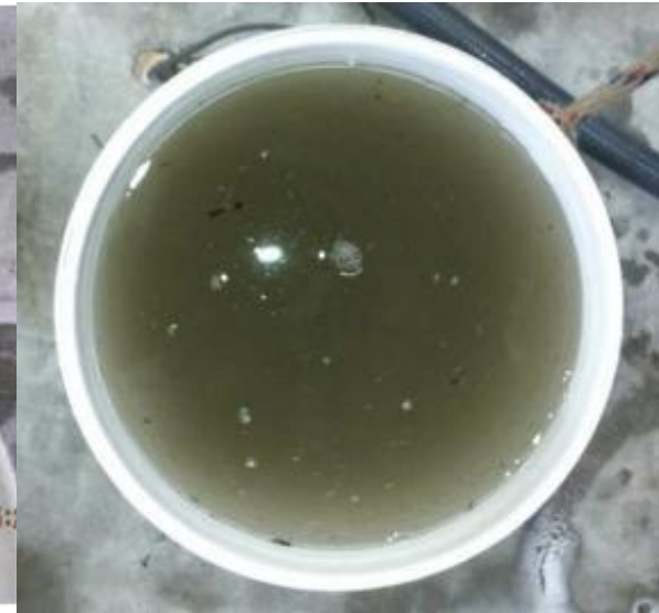
Agua de lavado de filtro Amiad
